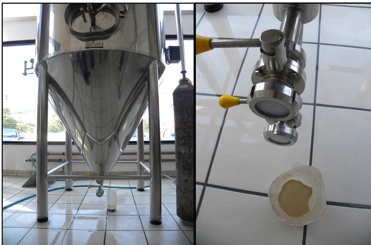
Figura 5. Dorna para fermentação do mosto. O “levedo” de cerveja, subproduto constituído por leveduras de cerveja ( Saccharomyces cerevisiae ) e cerveja, é sedimentado na parte inferior e posteriormente drenado.
