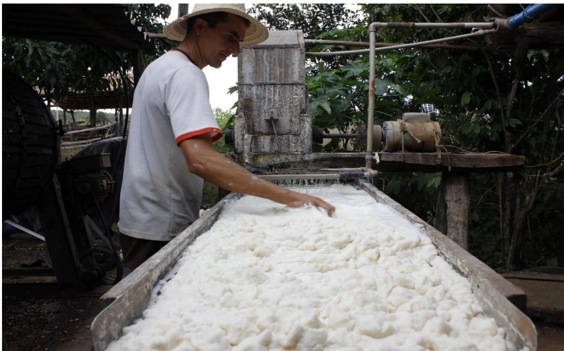
Foto 32: Ralador hidráulico com peneira
