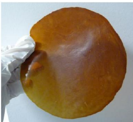
Figura 39. Filme elaborado por extrusão termoplástica
