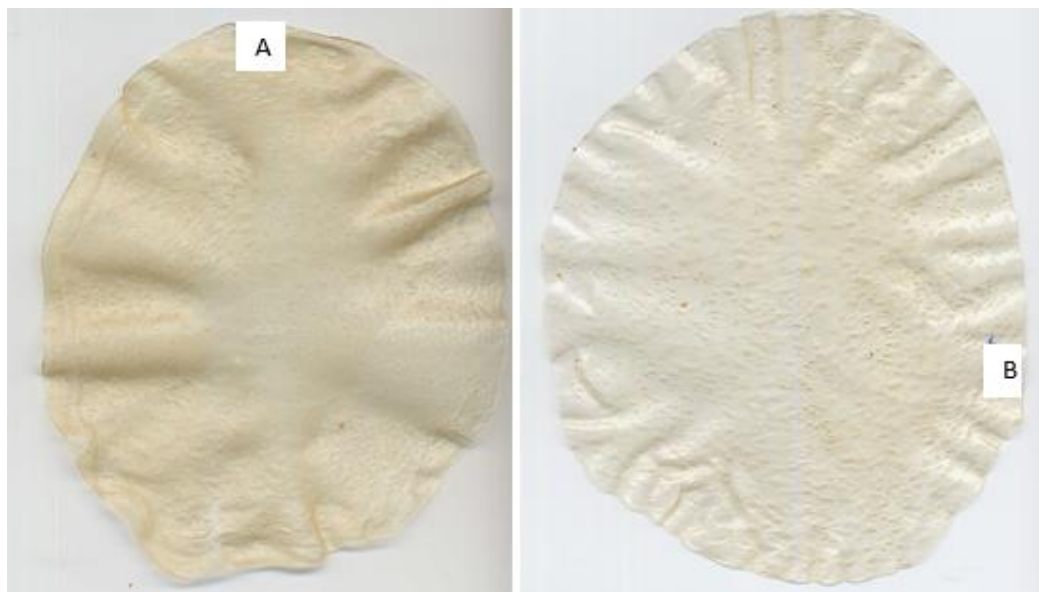
Figura 35. Imagem digitalizada dos filmes de amido de mandioca e polpa de acerola sem glicerol (A), e filme de amido de mandioca, polpa de acerola e glicerol (B).
