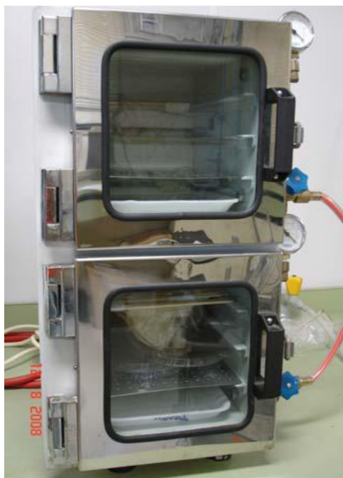
Figura 17. Câmara hermética a vácuo (Marconi, São Paulo, Brasil) usadas no condicionamento dos filmes.
