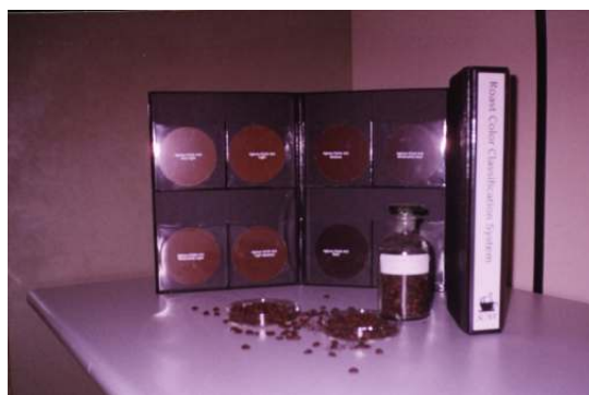
Figura 2. Kit de classificação de pontos de torra por discos colorimétricos AGTRON/SCAA
