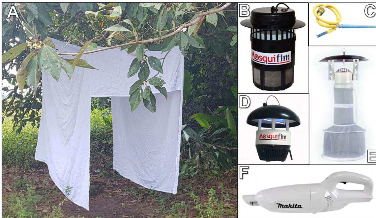
Figura 37. Armadilha luminosa de Shannon (A); Armadilha luminosa MF300 (B); capturador de Castro (C); Armadilha luminosa MF60 (D); Armadilha luminosa do tipo CDC (E); Aspirador elétrico (F). Fonte: Cecilia Mello
