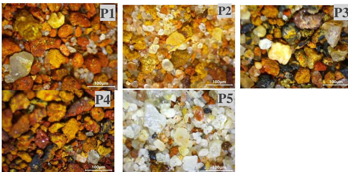
Figura 26. Micrografias de concreções associadas a fração areia grossa de horizontes diagnósticos subsuperficiais de solos do Vale do Araguaia, Goiás
