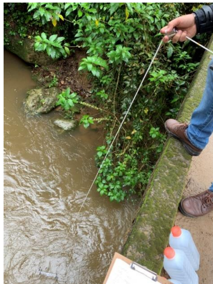
Figura 11. Coleta de água com auxílio do amostrador. Fonte: The Nature Conservancy (TNC). Comunicação pessoal, 2020.
