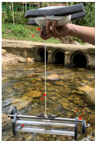
Figura 12. Coletor de água horizontal. Descrição: a) Amostrador, 1200ml. b) Linha calibrada possibilitando determinar a profundidade de coleta. c) Mecanismo para abrir as tampas. d) Cilindro para travar ambos os lados, as tampas fecham a amostra na profundidade escolhida e impedem que haja contaminação com misturas de
