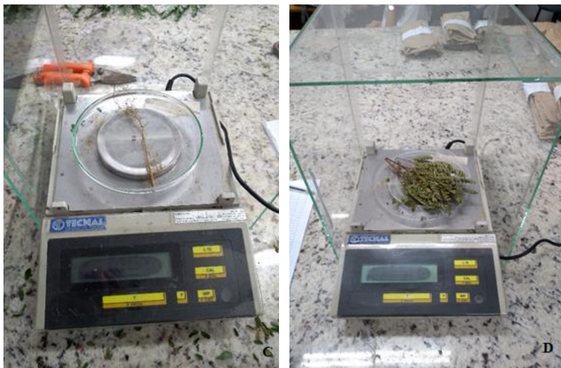
Figura 4: Medições em laboratório. A - Separação das mudas por tratamento e repetição em laboratório. B - Embalagens de papel contendo raízes e parte aérea das mudas. C – Raízes sendo pesada em balança de precisão após a secagem. D – Parte aérea sendo pesada em balança de precisão após secagem.
