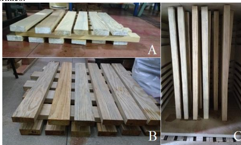
Figura 2. Tratamento térmico. A. Sarrafos antes do tratamento térmico. B. Sarrafos depois do tratamento térmico. C. Sarrafos dispostos na Mufla antes do tratamento térmico.
