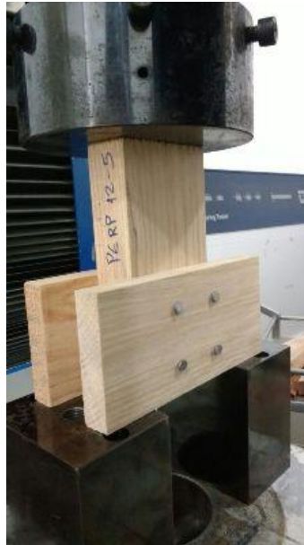
Figura 14. Corpo de prova centralizado no ensaio da ligação na direção perpendicular às fibras, com as cobre-juntas apoiadas nas extremidades.
