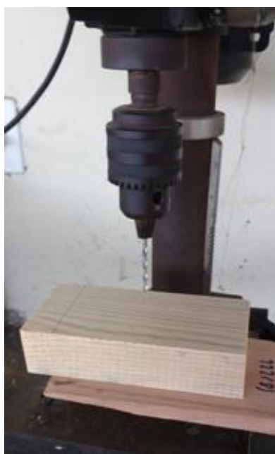
Figura 9. Pré-furação da peça central, demarcada onde os pregos serão inseridos.
