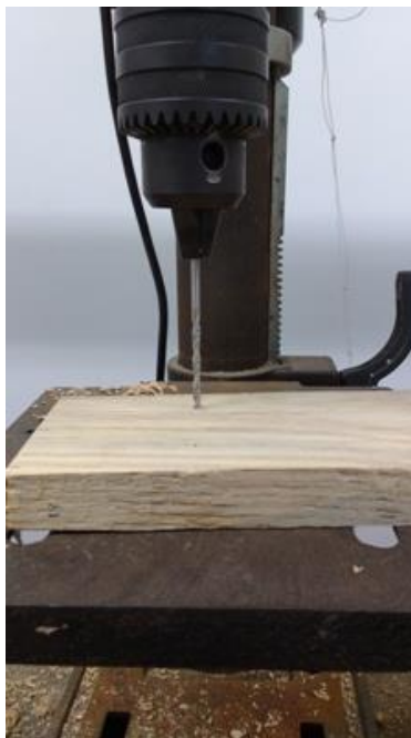
Figura 4. Pré-furação da peça com broca de 3,5 mm.
