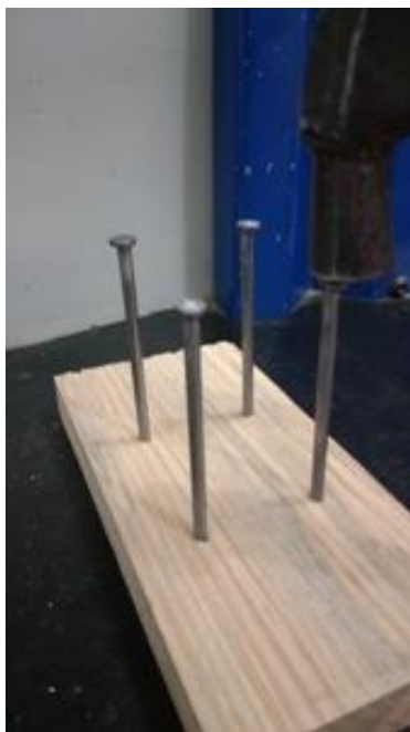
Figura 7. Cravação dos pregos em uma peça de cobre-juntas com o auxílio do martelo.
