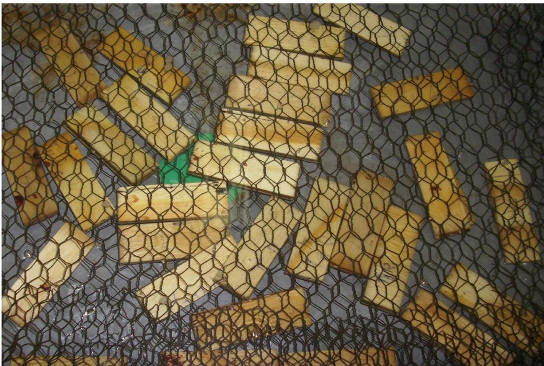
**Figura 5.** Corpos-de-prova durante teste de Absorção de Água.
