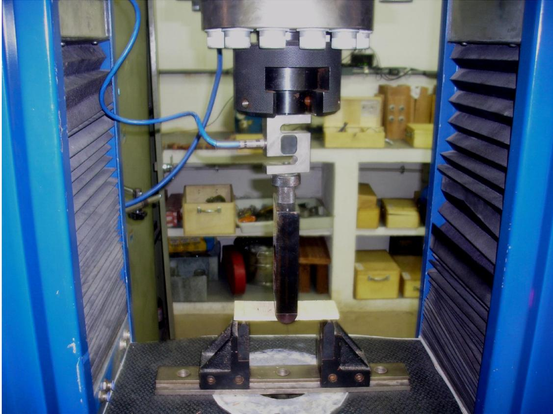
**Figura 6.** Ensaio de Resistência à Flexão Estática em execução.
