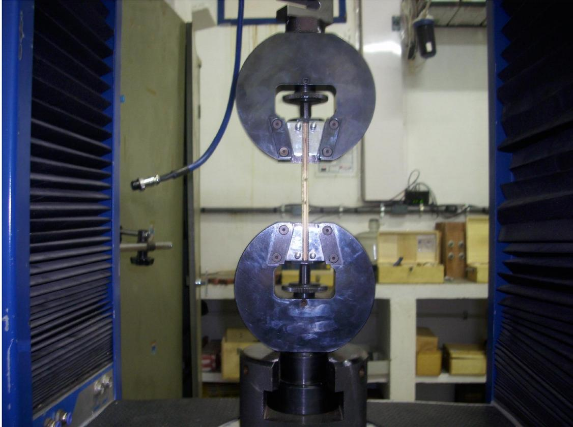
**Figura 7.** Ensaio de cisalhamento na linha de cola em execução.
