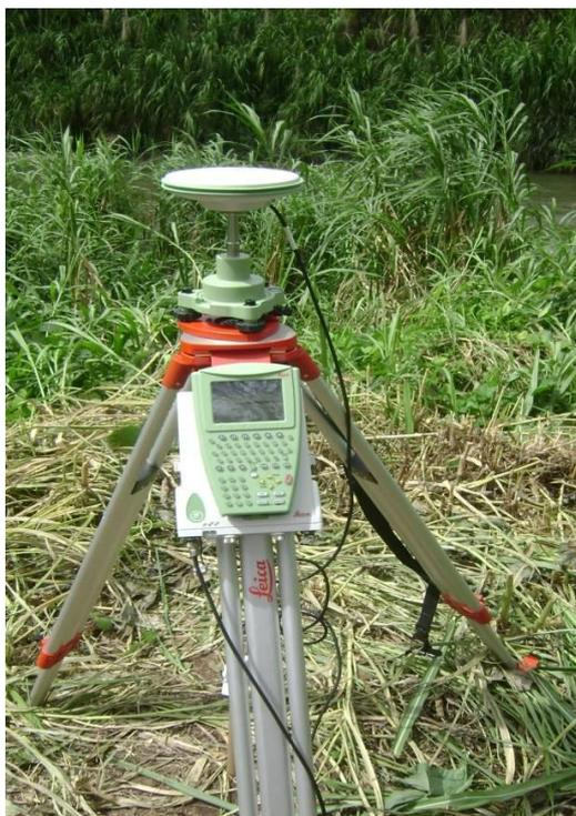
**Figura 6(b):** GPS Geodésico.
