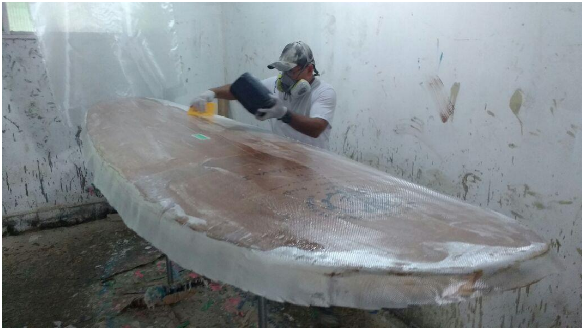
Figura 48. Laminação com a fibra de vidro.
