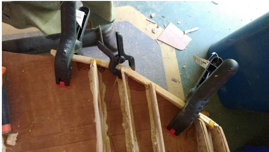
Figura 27. Encaixe, colagem e prensagem da ripa de agave formando a borda da prancha.
