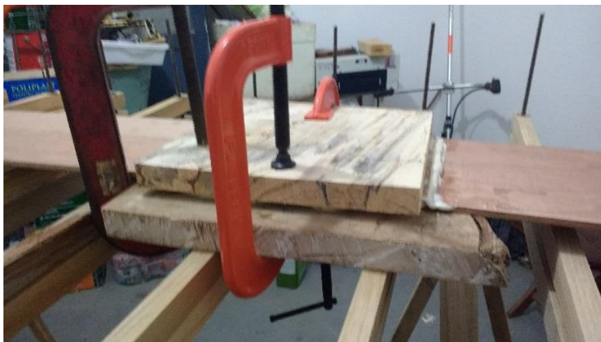
Figura 16. Prensagem da colagem da peça da longarina auxiliada por sargentos e peças de madeira.
