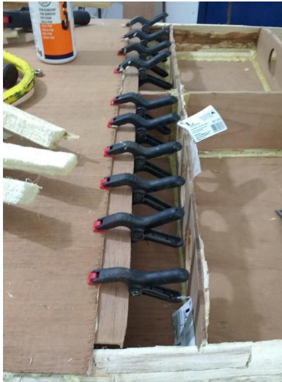
Figura 36. Colagem da emenda do deck.
