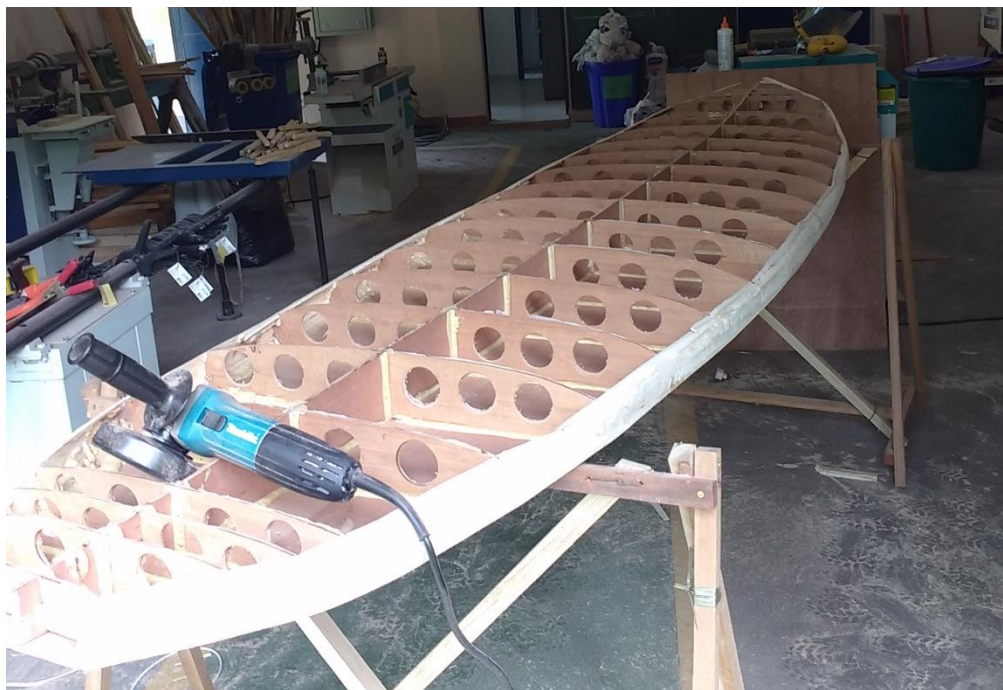
Figura 33. Redução das diferenças de alturas entre longarina e bordas para colagem do deck.
