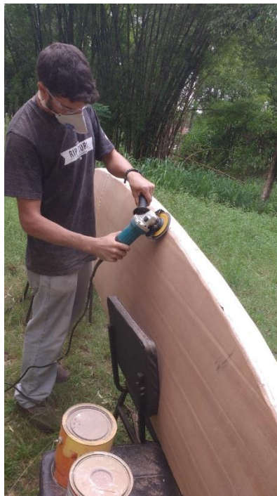
Figura 52. Correção de tortuosidade gerada no lixamento da borda direita.
