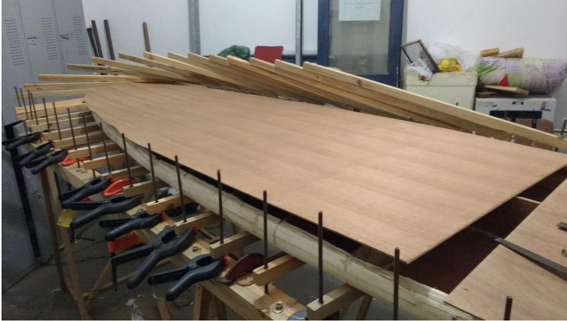
Figura 34. Posicionamento da primeira folha e marcação dos pontos de colagem e prensagem.
