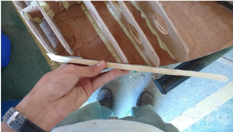
Figura 24. Medição e posicionamento das fendas de encaixe das ripas nas cavernas.
