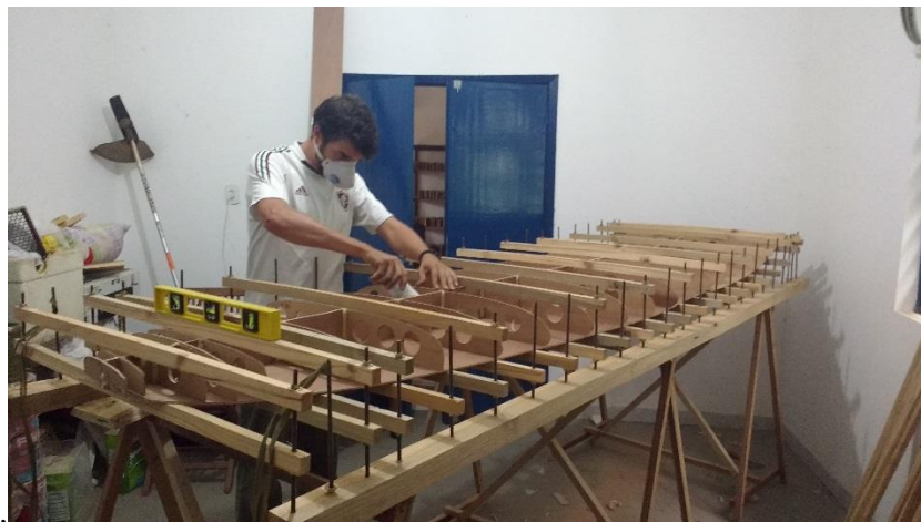
Figura 22. Colagem do bottom.
