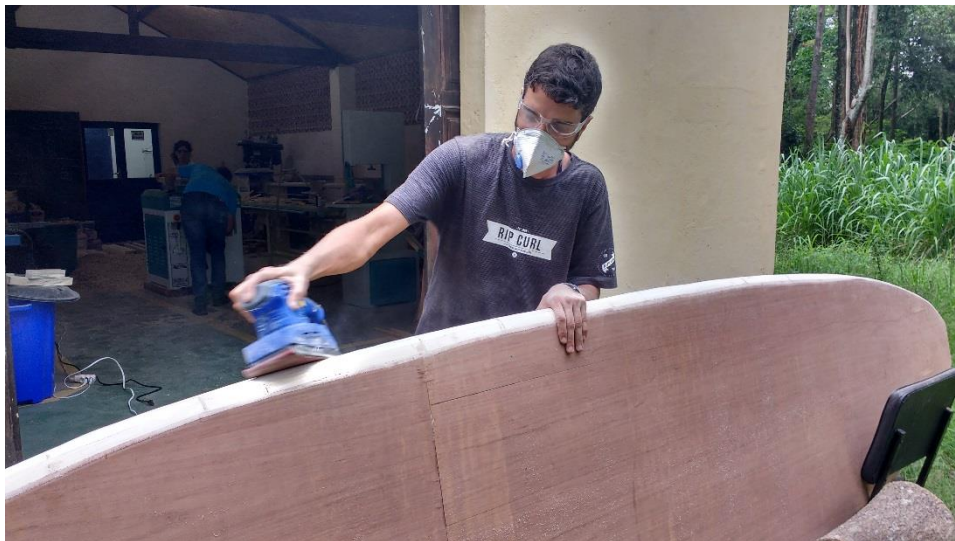
Figura 39. Lixamento da curva de borda no deck.
