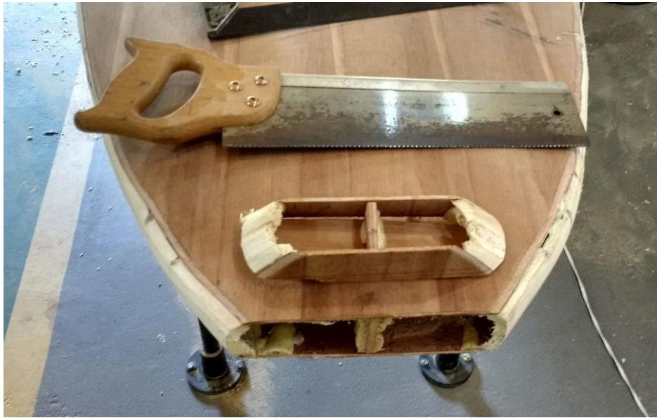
Figura 40. Corte das extremidades para confecção do bico e rabeta.
