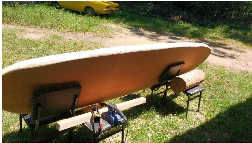
Figura 30. Bordas após aplainamento e lixamento primário.
