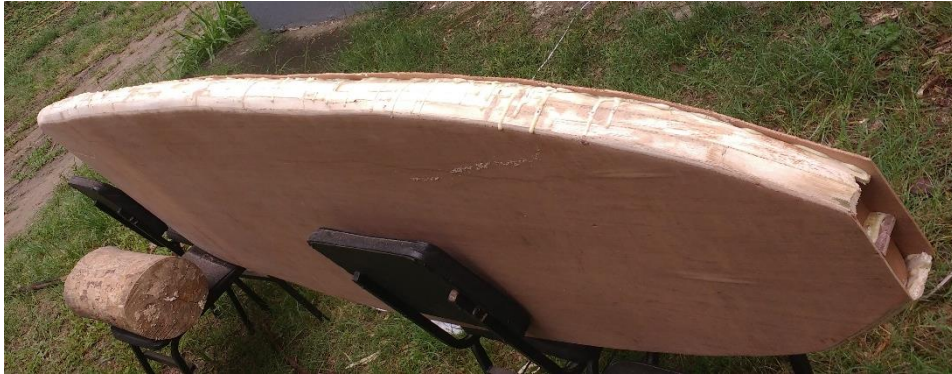
Figura 38. Prancha antes da retirada de anteparas do deck e novo aplainamento das bordas.
