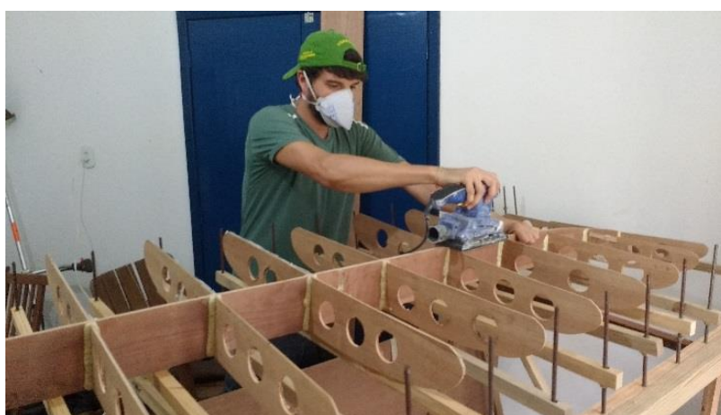
Figura 20. Lixamento das rebarbas de cola seca e nivelamento da face inferior da longarina e cavernas.
