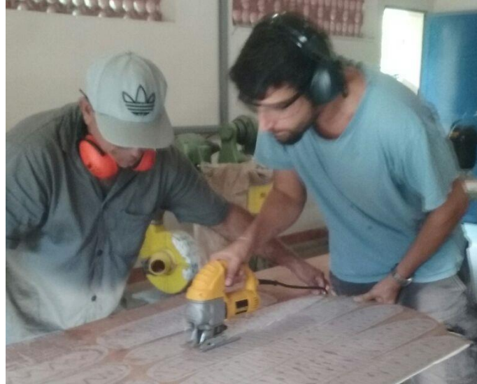
Figura 15. Recorte do compensado após colagem do papel vegetal com desenho das cavernas.
