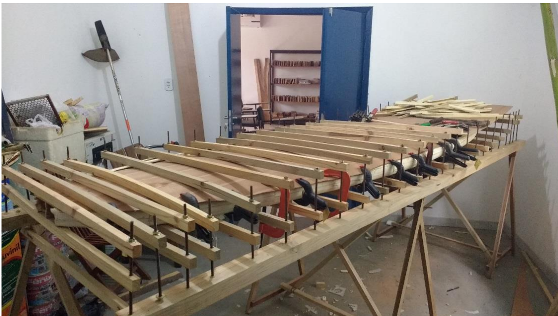
Figura 35. Colagem e prensagem da primeira parte do deck.
