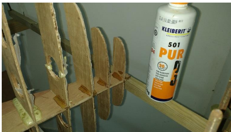
Figura 19. Cola PUR utilizada nos processamentos e reparo de caverna quebrada acidentalmente.
