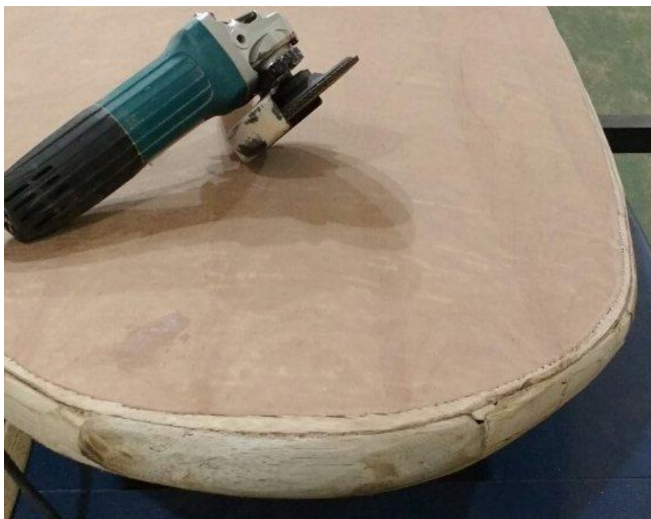
Figura 42. Abaulamento do bico com esmerilhadeira e lixadeira.
