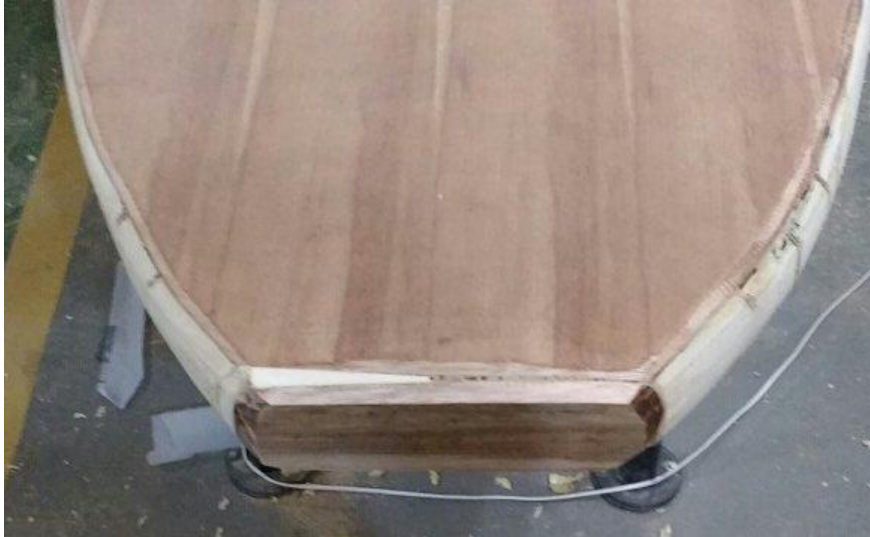
Figura 53. Colocação de cunha para aprumar a rabeta da prancha.
