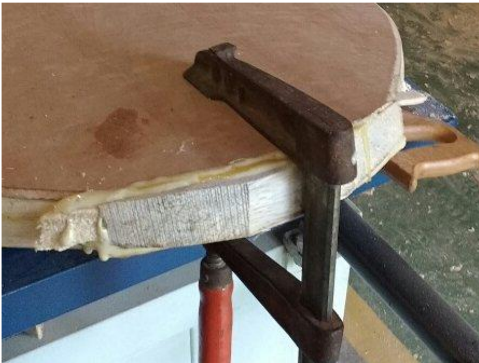
Figura 41. Inserção e colagem de peça de madeira para o bico.
