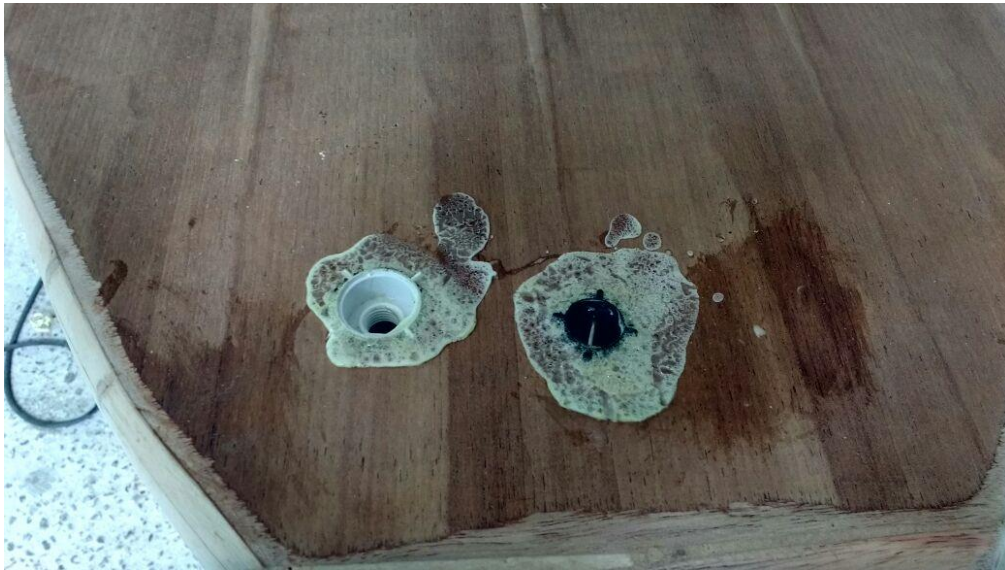
Figura 46. Detalhes da furação para a válvula e prendedor do step.
