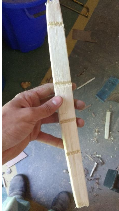
Figura 26. Fendilhamento das ripas com auxílio de serrote.
