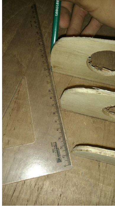
Figura 21. Medição e desenho do formato do bottom.
