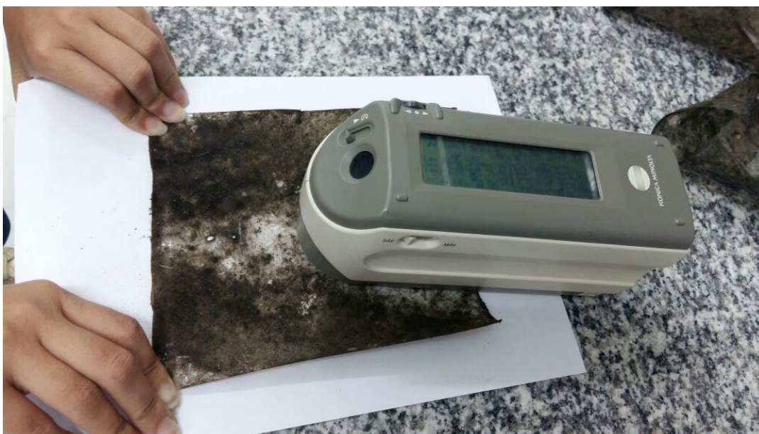
Figura 10. Mensuração da influência da colonização pelos microrganismos na alteração da cor original do equipamento pelo espectrofotômetro portátil CM 2600d da Konica Minolta.
