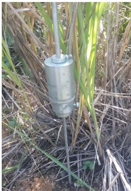
Figura 12: Operação com o penetrômetro de impacto Stolf.
