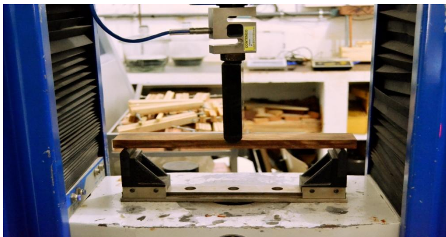
Figura 13: Ensaio de módulo de elasticidade na máquina universal de ensaios mecânicos.
