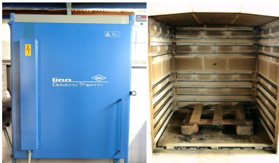
Figura 11: (A) Forno mufla elétrica laboratorial, da marca Linn Elektro Therm, utilizado para a aplicação dos tratamentos termorretificadores. (B) Interior do forno mufla e posicionamento das amostras de madeira de Corymbia citriodora .
