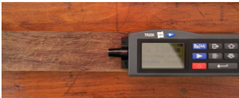
Figura 16: Medição da rugosidade na amostra da madeira de Corymbia citriodora pelo aparelho portátil TR200/DIGIMESS.
