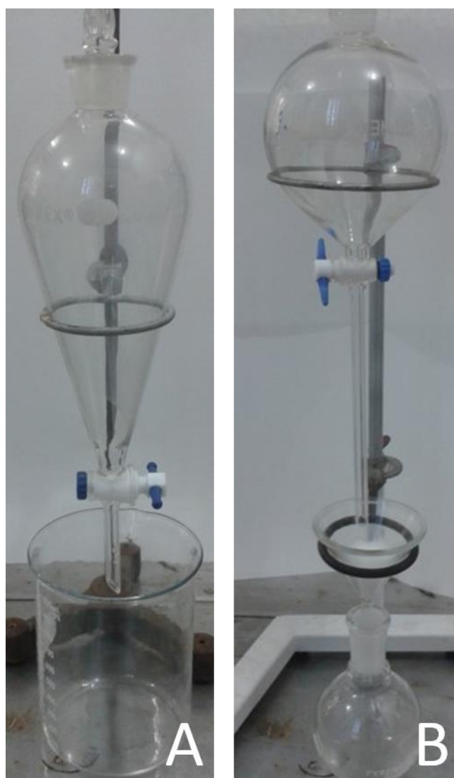
Figura 7: A: Funil de separação para extração com clorofórmio; B: Funil de separação em conjunto com um funil preenchido com algodão e sulfato de sódio anidrido
