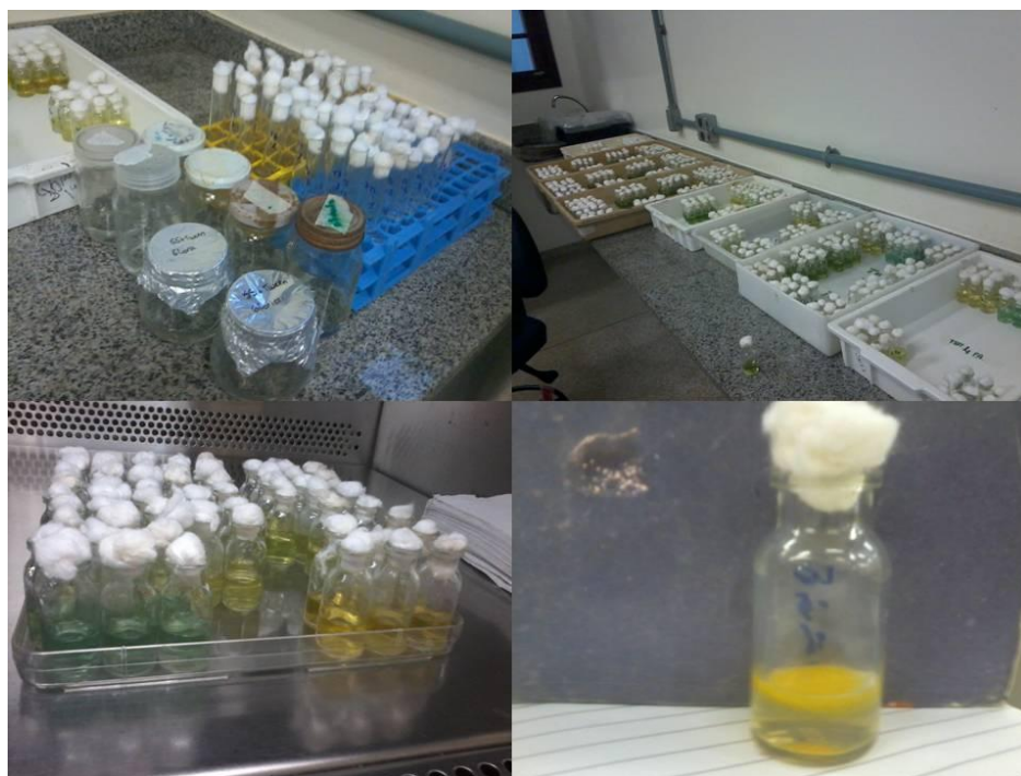
Figura 2. Contagem NMP – Inoculação de amostras diluídas e formação de película após 5 dias de incubação a 30°C
