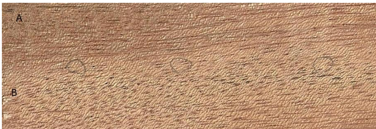
Figura 11. Visão dos vasos em corte e longitudinal (A) e diagonal (B) de uma amostra de madeira de Khaya ivorensis revelando a grã reversa.
