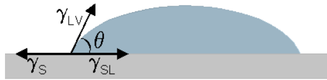
Figura 2. Definição do ângulo de contato \theta entre uma gota líquida e uma superfície plana e horizontal (Fonte: YOUNG, 1805).
