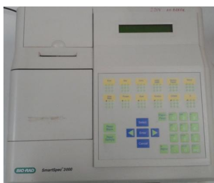
Figura 4: Espectrofotômetro Bio-Rad SmartSpec™ 3000, utilizado para quantificação da concentração e grau de pureza de DNA.
