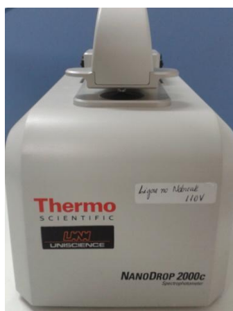
Figura 5: Spectrophotometer Nanodrop 2000c Thermo Scientific, utilizado para quantificação da concentração e grau de pureza de DNA.
