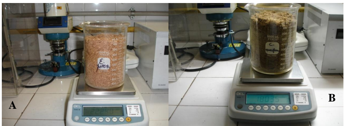
Figura 3. Pesagem de volumes conhecidos de resíduos de E. pellita (A) e C. nucifera (B), para a determinação das massas específicas aparentes antes do processo de briquetagem.
