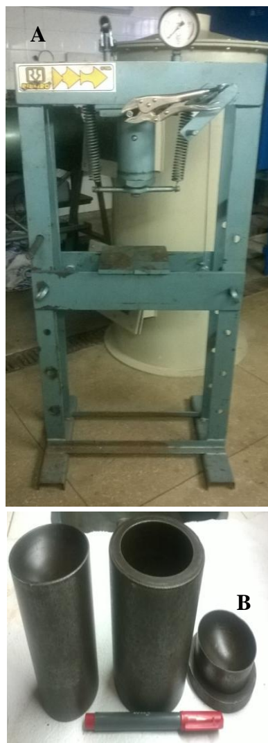
Figura 1. Prensa hidráulica (A) e molde de aço (B) usados na produção dos briquetes.
