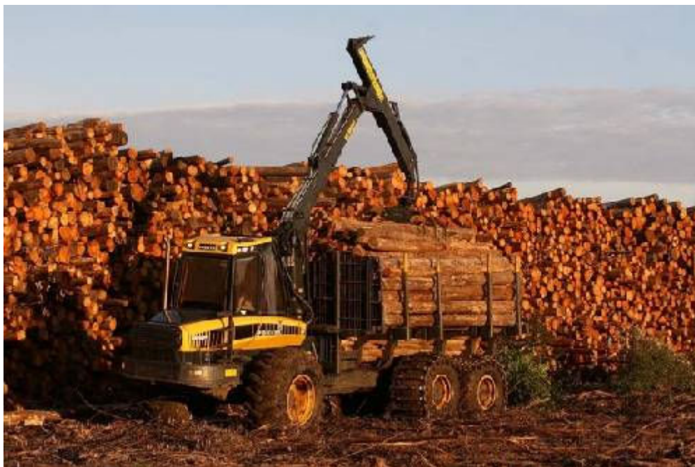
Figura 15: Forwarder autocarregável. (Fonte: Ponsse).
