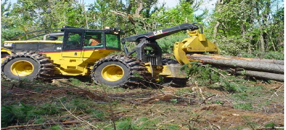
Figura 14: Skidder com grua. (Fonte: Caterpillar).
