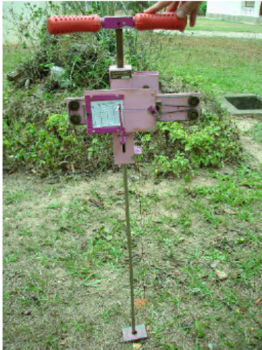
Figura 9: (a) Penetrógrafo utilizado para a realização dos testes de resistência à penetração. (b) Exemplo do gráfico gerado pelo penetrógrafo.
