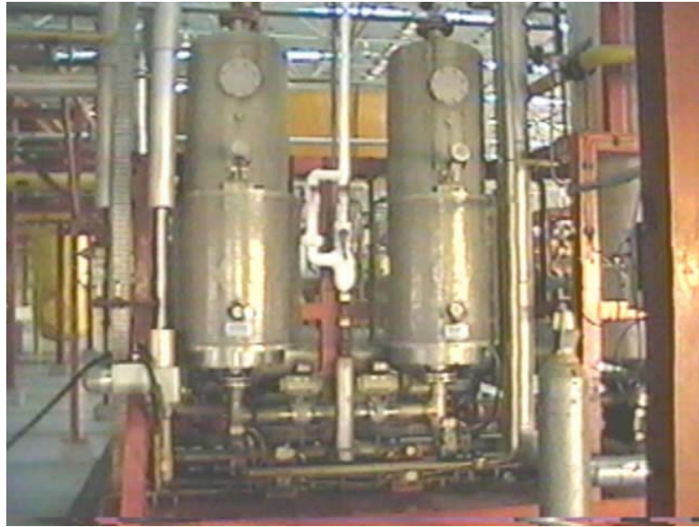
Figura 8: Ilustração dos secadores de CO 2 .
