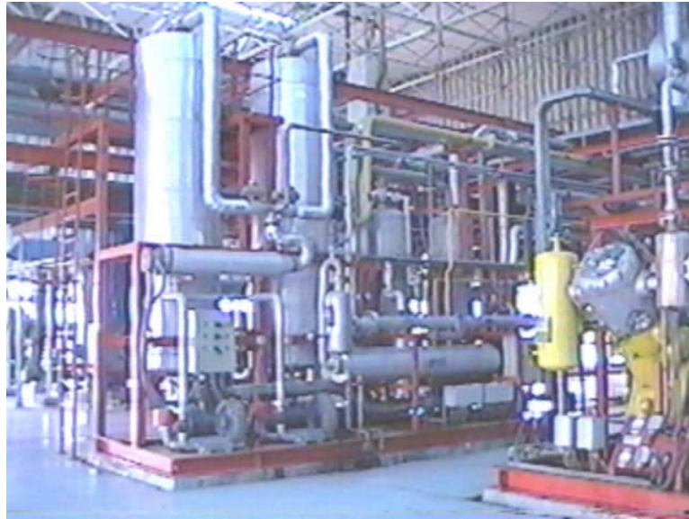
Figura 9: Ilustração de um desorizador de CO 2 .
