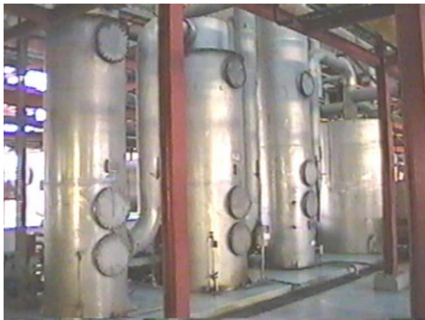
Figura 7: Ilustração dos lavadores de CO 2 por coluna de água
