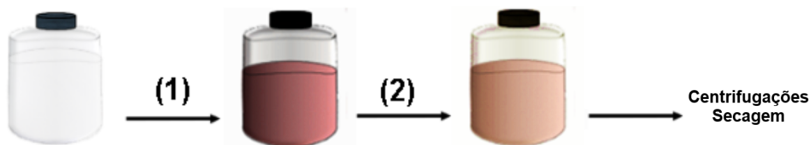
Figura 1. Processo de obtenção dos compósitos: 1 - Dissolução de frutose e precursor metálico em etilenoglicol, aquecimento e agitação a 105 °C (8 ou 3h); 2 - Adição da mistura sobre suspensão de \text{Nb}_2\text{O}_5 em etilenoglicol a (105 °C, 2h).
