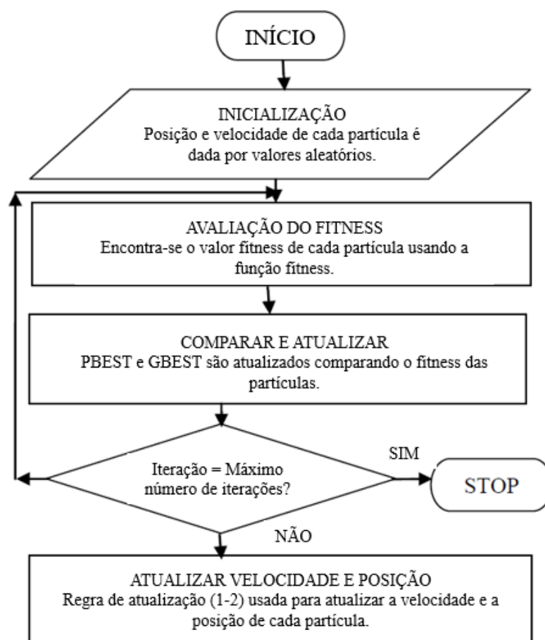
Figura D.3. Fluxograma do algoritmo de enxame de partícula (Adaptado de JUNEJA; NAGAR, 2016.).
