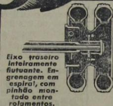
Eixo traseiro inteiramente fixante. Engrenagem em espiral, com pinhão montado entre rolamentos.
