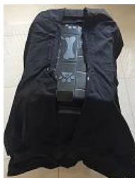
Figura 19- Registro fotográfico da parte superior da caixa de revelação com a colocação dos tecidos de brim.
