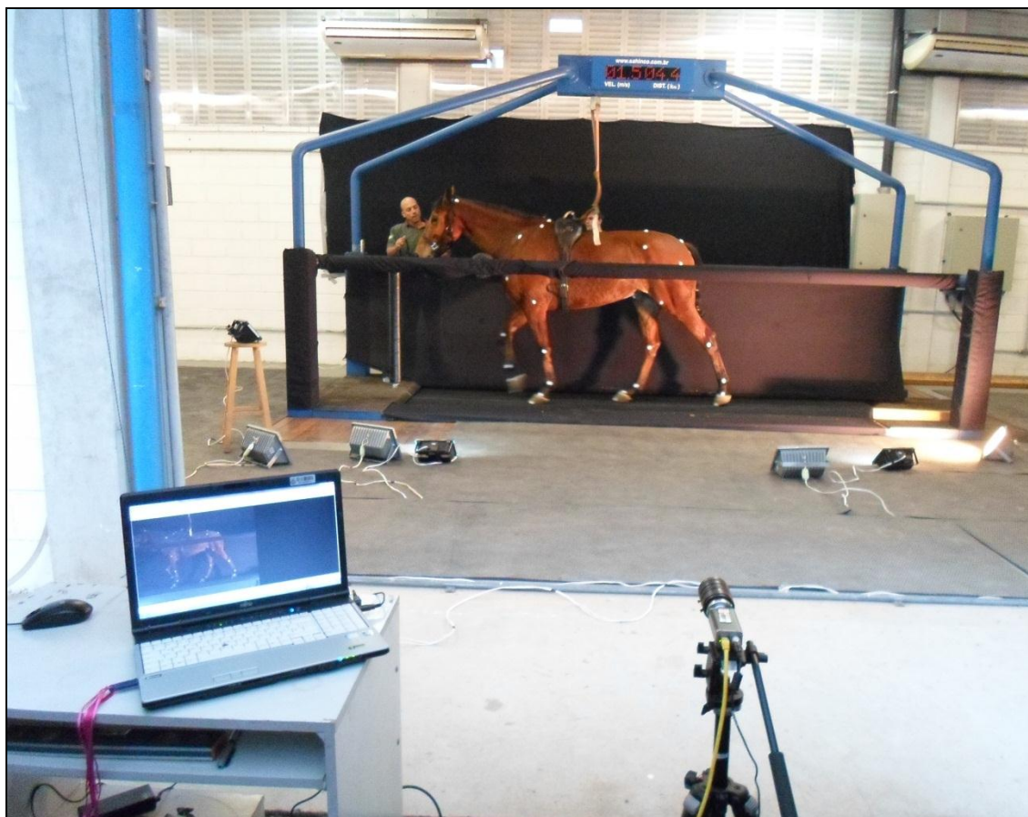
Figura 9. Estrutura montada e captura de imagens na esteira.
