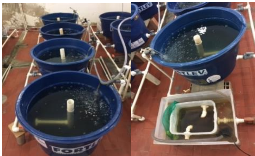
Figura 1. Disposição dos tanques no sistema de recirculação.
