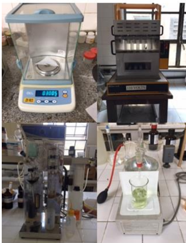
Figura 5. Análise da proteína bruta pelo método de Kjeldahl.
