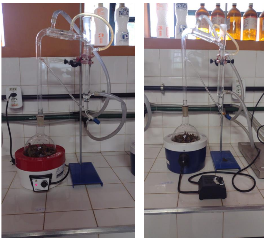
Figura 15. Sistema de hidrodestilação contendo aparelho de tipo Clevenger modificado.
