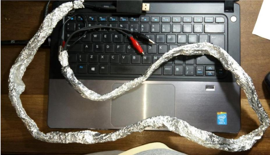
Figura 14 – Osciloscópio para PC já com a blindagem
