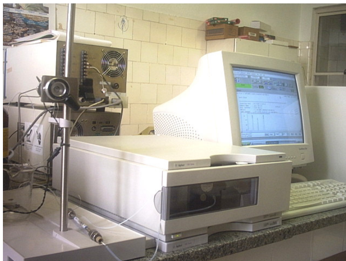
Figura 5: Cromatógrafo a líquido equipado com: detector de fluorescência Agilent, modelo 1100 Series, injetor de loop fixo de 20 \mu L (Rheodyne), coluna Microsorb MV, C18 5 \mu , 15x4.6mm, Varian e Chemstation Plus da Agilent.
