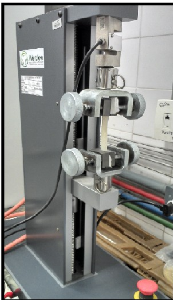
Figura 2- Foto da máquina universal de ensaio AME ® (Técnica Industrial Oswaldo Filizola) capacidade de 5kN localizada no Instituto de Macromoléculas da Universidade Federal do Rio de Janeiro. Nota-se o pericárdio bovino em repouso posicionado no aparelho, destacado pela seta.
