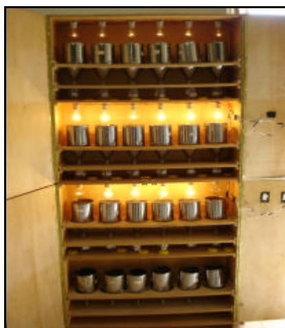
Figura 3. Vista do equipamento para coleta da mesofauna edáfica.
