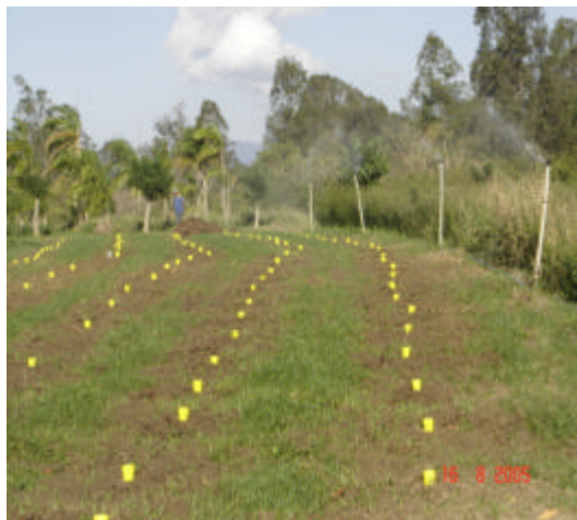
Figura 6. Teste de precipitação para avaliação da eficiência do sistema de irrigação em área sob cultivo de mamoeiro.
