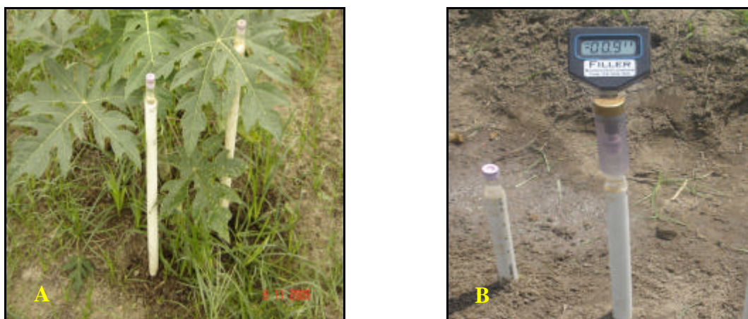
Figura 7. Vista do equipamento para monitoramento da umidade de solo cultivado com plantio de mamoeiro ( Carica papaya ) em duas profundidades, por meio do uso de tensiômetros (A) com leituras feitas a partir de tensímetro (B).
