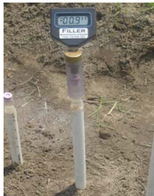
Figura 11 - Tensímetro da marca FILLER, utilizado para monitorar a tensão da água no solo.
