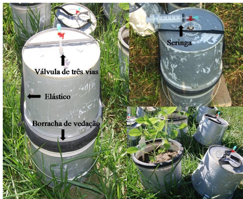
Figura 4. Esquema da câmara utilizada para coleta do gás.
