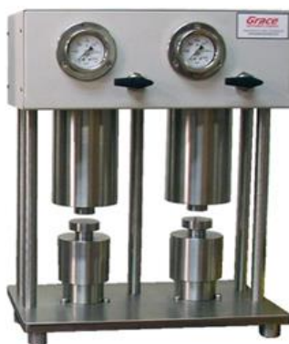
Figura 26. M4600 célula de compressão. Fonte: Manual Grace instruments.
