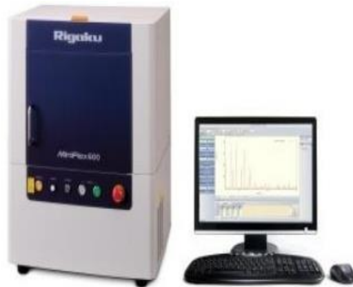
Figura 21. Difrator de raios X. Fonte: Rigaku (2016).
