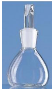
Figura 20. Picnômetro. Fonte: Pró-análise (2016).
