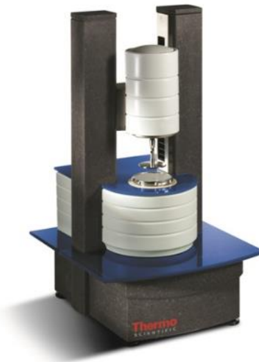
Figura 30. Reômetro Haake RheoStress 1 - Thermo Scientific. Fonte: Thermo Fisher (2016).
