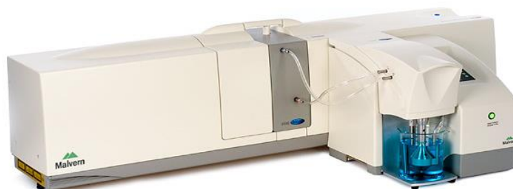
Figura 24. Analisador de partículas com difração a laser. Fonte: Malvern (2016).
