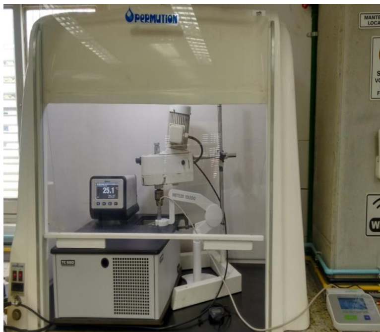
Figura 38. Unidade utilizada para realização dos testes de cinética de dissolução de sal.
