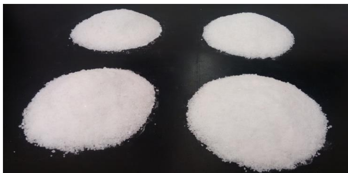
Figura 22. Amostras subdivididas de sal pela técnica de pilha cônica.
