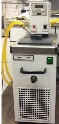
Figura 32. Foto do banho de água utilizado para controlar a temperatura.
