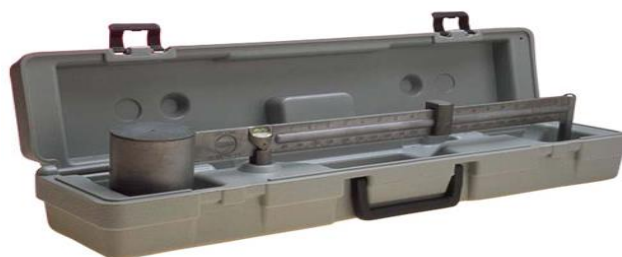
Figura 28. FANN Balança de Lama. Fonte: Eurosul (2016).
