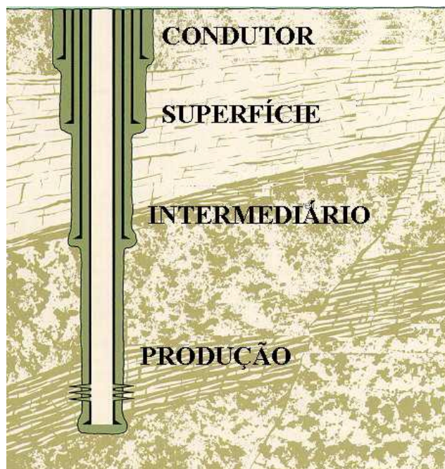
Figura 1: Desenho esquemático das fases de cimentação de um poço de petróleo (MIRANDA, 2008).
