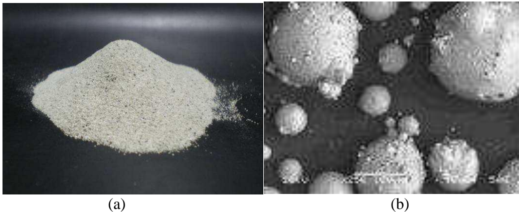
Figura 2: (a) Microesferas de cerâmicas; (b) Micrografia obtida por microscopia eletrônica de varredura aumentada 250 vezes (MIRANDA, 2008).
