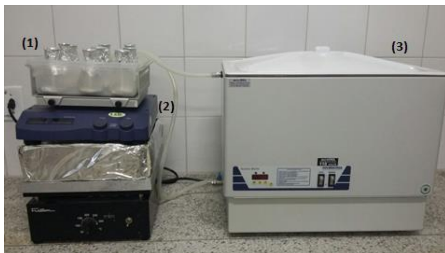
Figura 11 - Aparato experimental usado nos ensaios em batelada, sendo: (1) erlenmeyers com solução glicerol/adsorvente; (2) mesa agitadora, (3) banho termostático.
