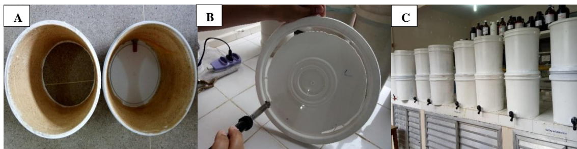
Figura 6. Detalhe da parte superior e inferior da coluna de filtração (A) e da abertura circular realizada para unir as partes da coluna (B) e o produto final com as colunas de filtração após confecção (C).
