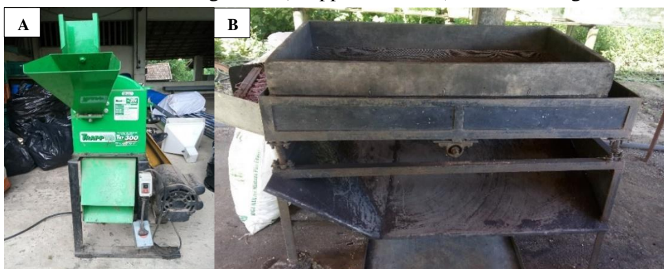
Figura 8. Triturador utilizado na pesquisa (A) e peneiras mecânicas com malhas de 4 mm na parte superior e 2 mm na parte inferior (B).
