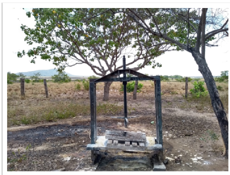
Figura 80 – Prensa de madeira utilizada para secar a massa de mandioca e retirar o tucupi, ao lado da casa de farinha da Comunidade Araçá
