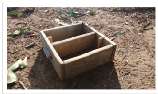
Figura 51 – Fôrma em madeira para confecção dos tijolos de adobe
