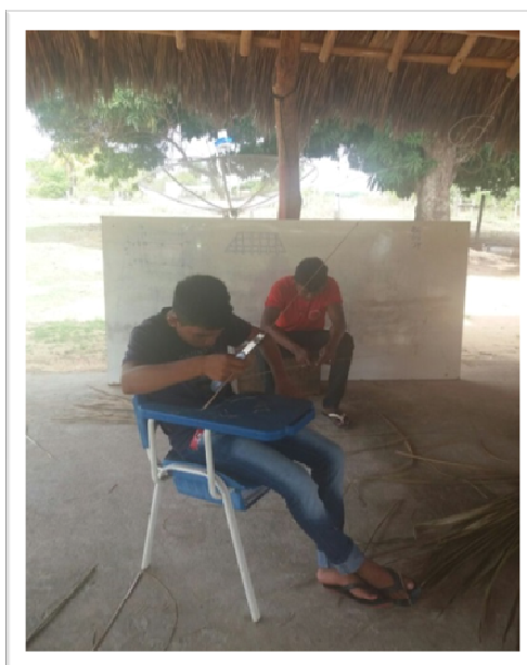
Figura 113 – Confecção das ripas feitas com talos das palhas Fonte: a autora.
