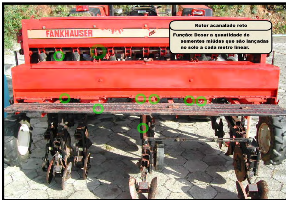
Figura 13 – Identificação da localização e da função de cada componentes da semeadora-adubadora modelo 1013 da Fankhauser
