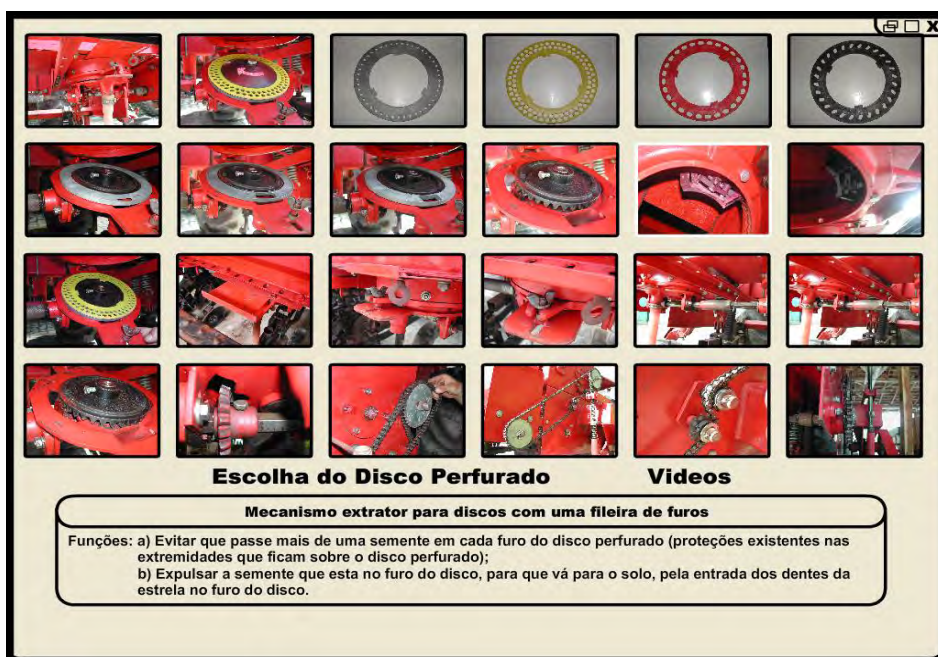
Figura 14 – Sub-grupos de componentes complexos da semeadora-adubadora modelo 1013 da Fankhauser
