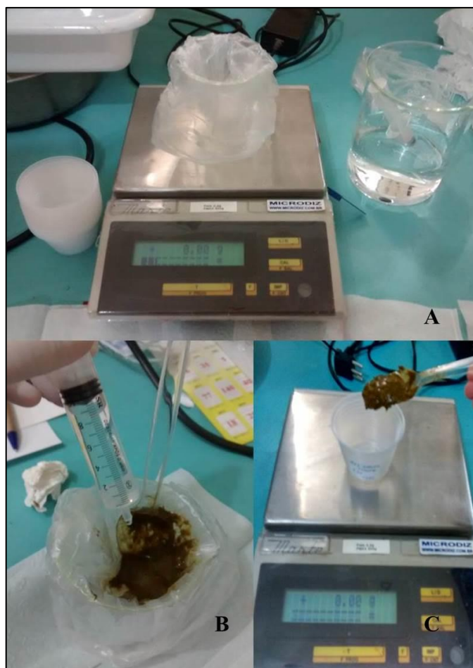
Figura 6. Balança de precisão, béquer coberto por saco plástico transparente e água ultrapura (A). Preparo do substrato para incubação dos ovos de Haematobia irritans (B). Pesagem do substrato para incubação dos ovos de Haematobia irritans (C).
