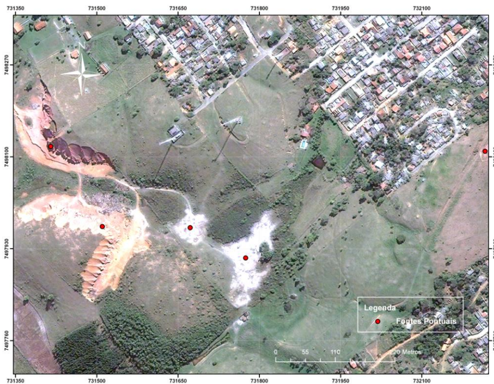
Figura 79: Exemplificação de fontes pontuais de emissão de sedimentos, dentro da bacia hidrográfica do rio Macacu/RJ. Áreas de mineração e áreas de empréstimos.
