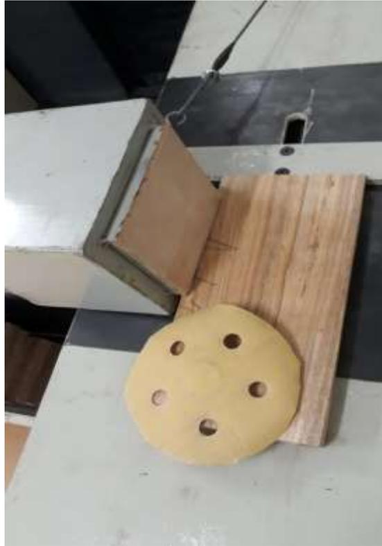
Figura 7: Bloco retangular de ferro com sola de couro e lixa para uniformizar a sola.
