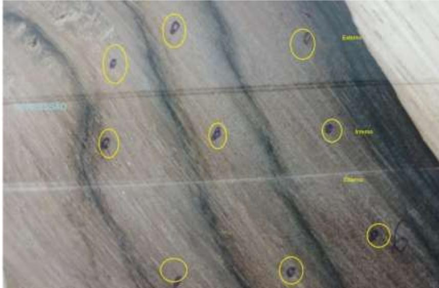
Figura 9: Amostras da madeira de Jacarandá com medição da profundidade da depressão após ensaio de carga rolante.
