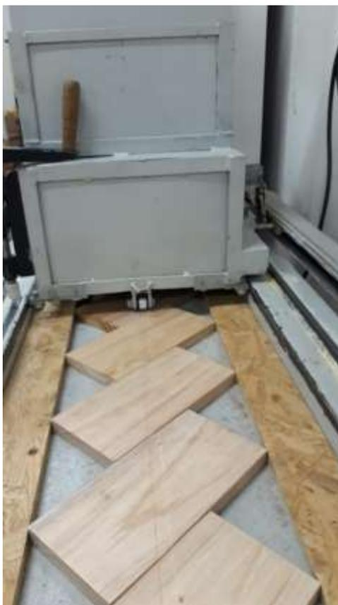
Figura 8: Máquina de ensaio de carga rolante. Fonte: Próprio autor
