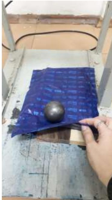
Figura 11: Folha de carbono para marcar a amostra após queda da esfera de aço. Fonte:
