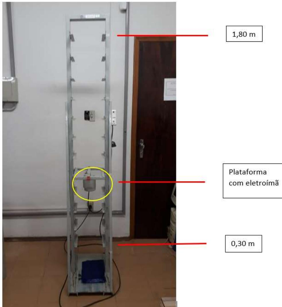
Figura 10: Máquina de impacto de esfera de aço cadente. Fonte: Próprio autor
