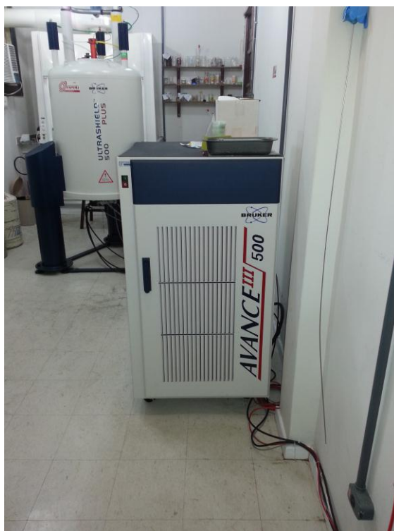
Figura 17. Espectrômetro de RMN de Hidrogênio e de ^{13}\text{C} . Ao fundo, rotor eletromagnético, usado em conjunto com o aparelho.
