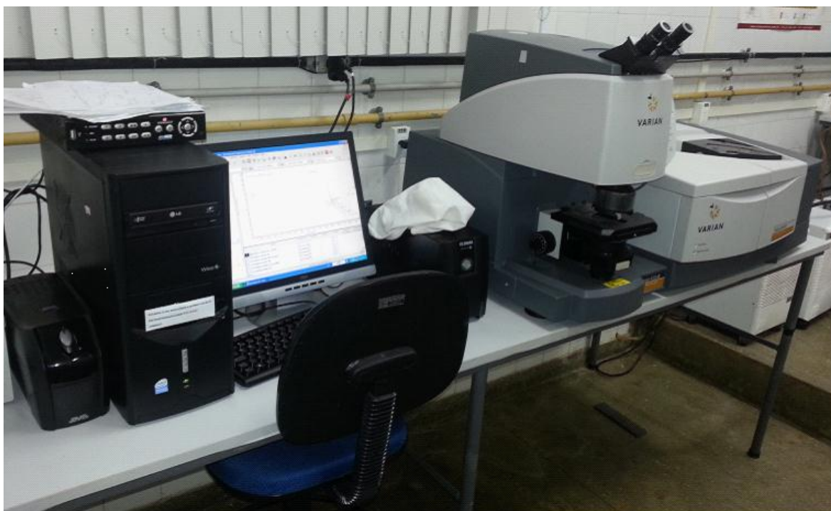
Figura 18. Espectrômetro de infravermelho acoplado a um microscópio, responsável pelo registro dos espectros.
