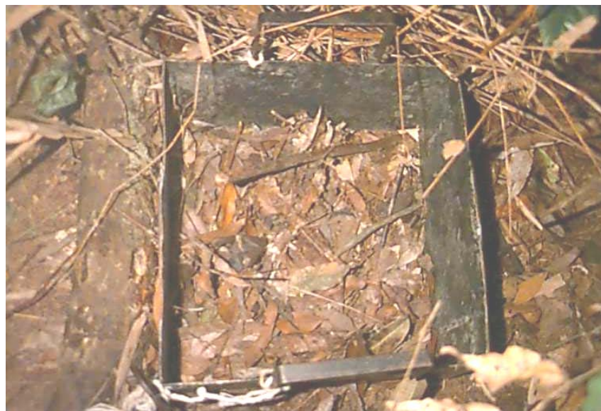
Figura 12: Vista superior do coletor metálico de amostras para análise de fauna do solo.
