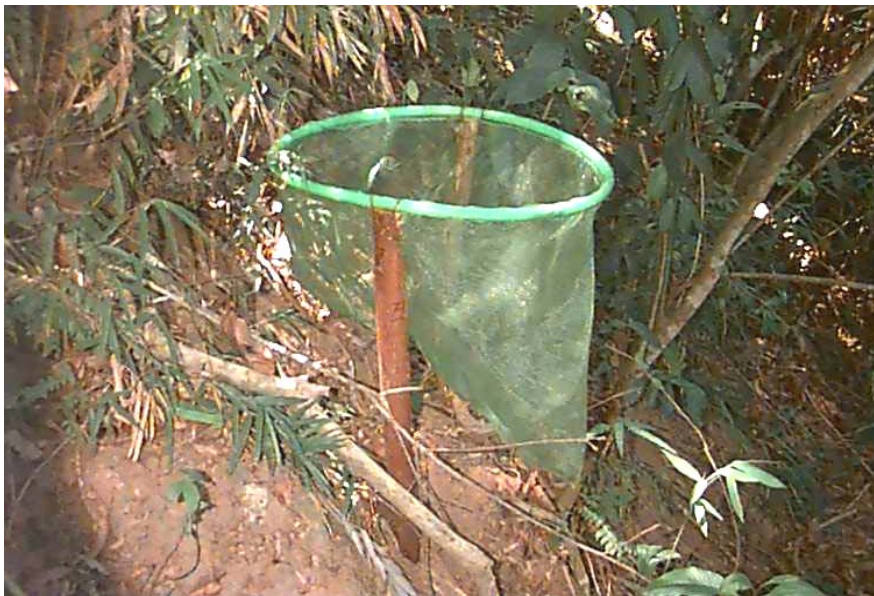
Figura 11: Vista lateral do coletor cônico utilizado para coleta de material formador da serrapilheira (MFS).
