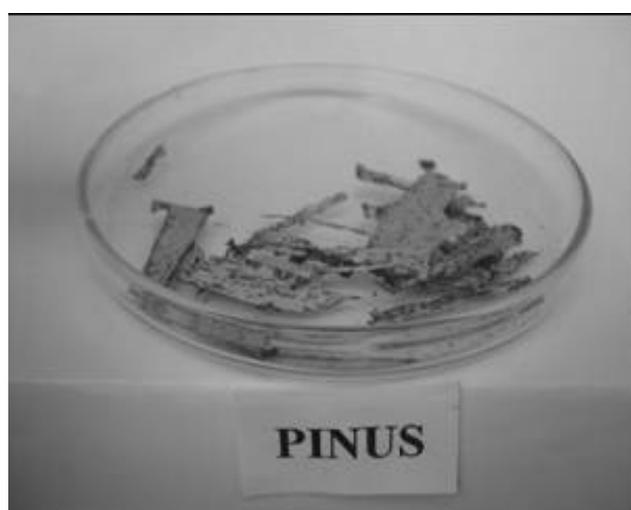
**Figura 5** Massa restante dos corpos-de-prova de *P. elliottii*, após 45 dias de exposição a *C. gestroi*
