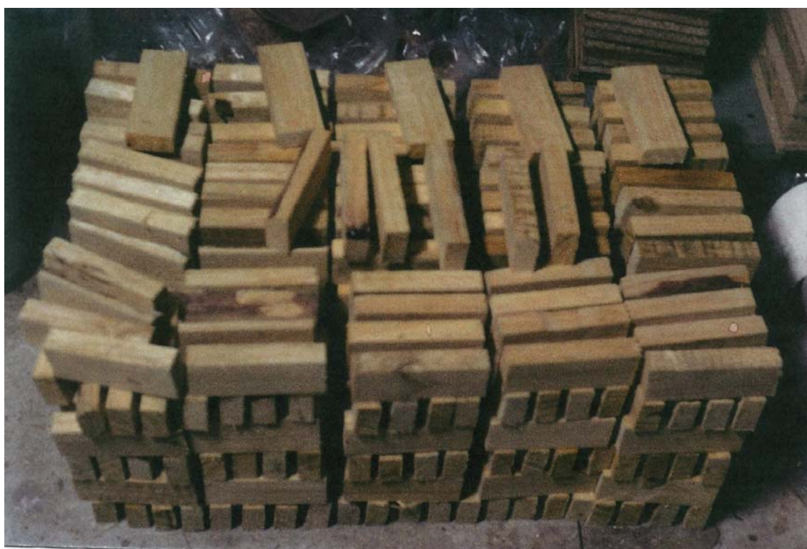
Figura 2. Corpos-de-prova no interior da câmara de climatização na fase de estabilização do teor de umidade residual.
