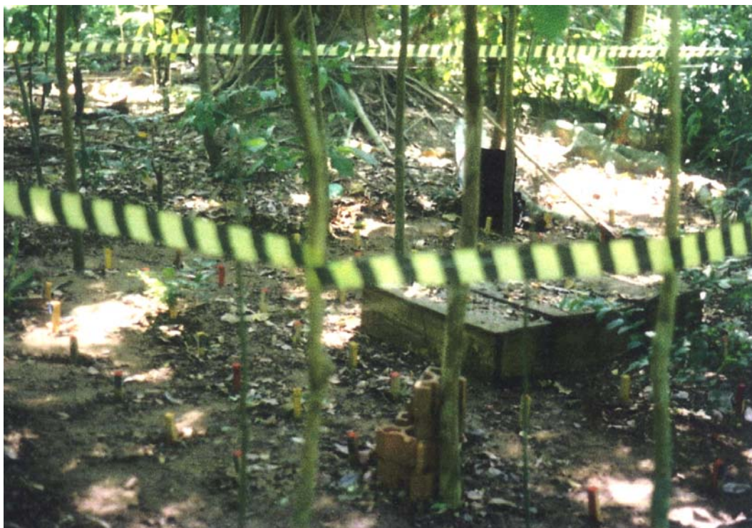
Figura. 12. Uma das áreas destinadas ao ensaio de eficiência das substâncias preservativas.
