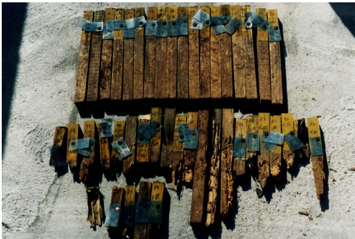
Figura 24. Estado final dos corpos-de-prova após 18 meses de exposição aos cupins.
