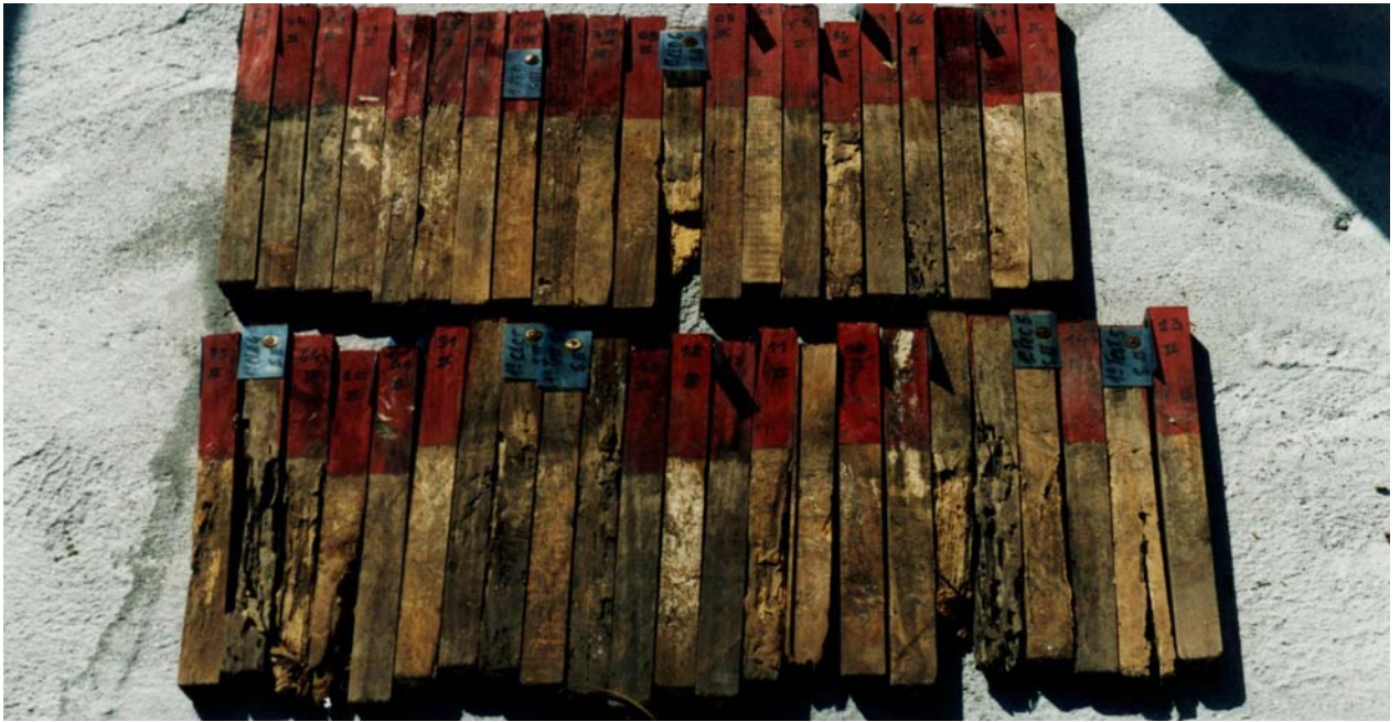
Figura 18. Estado final dos corpos-de-prova após 12 meses de exposição aos cupins.
