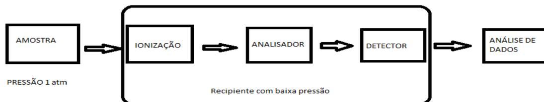
**Figura 11** – Esquema simplificado de um espectrômetro de massa
